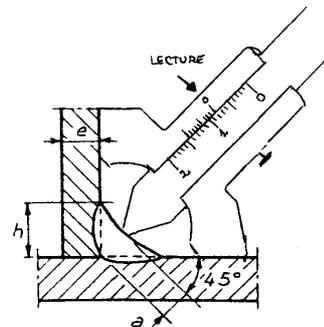
**Détermination de la surépaisseur d'un cordon** - dimension lue sur le vernier au 1/10<sup>è</sup>
