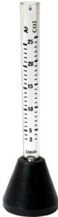
*Un débit gaz adapté est une des conditions de base pour un soudage correct en MIG ou en TIG. Un débit trop faible engendre des porosités par manque de protection gazeuse. Un débit trop fort risque de créer des porosités par effet de turbulence du gaz.*
