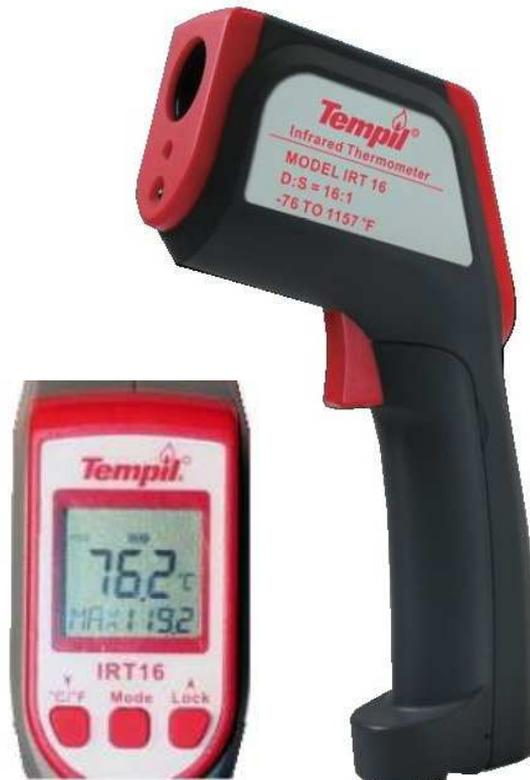
Thermomètre sans contact (infrarouge) conçu par TEMPIL (un grand nom de la mesure de température en soudage), qui fournit une lecture très rapide (environ 1 seconde) de -60 à 625°C, résolution 0.1°C (-76 à 1157°F) au point choisi.
