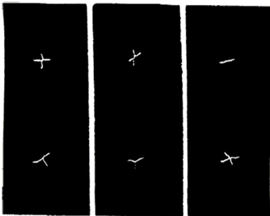
Les éprouvettes **RUNCHEK** se fixent normalement dans chaque panier de pièces ou à chaque balancelle. Elles conviennent aussi bien aux chaînes manuelles que semi-automatiques ou automatiques. Ces éprouvettes témoins peuvent être également fixées à chaque pièce dans le cas d'une application des produits de ressuage par pulvérisation électrostatique.
