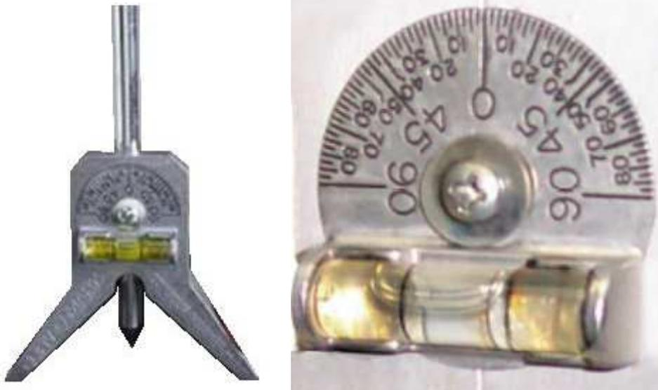
Ce pointeau se compose d'une structure en Y, d'un cadran gradué sur 180° et d'un niveau.
