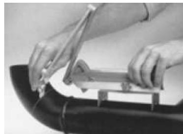
Ce système en aluminium moulé permet avec une craie de réaliser divers marquages sur tubes sans calcul ni gabarit.
