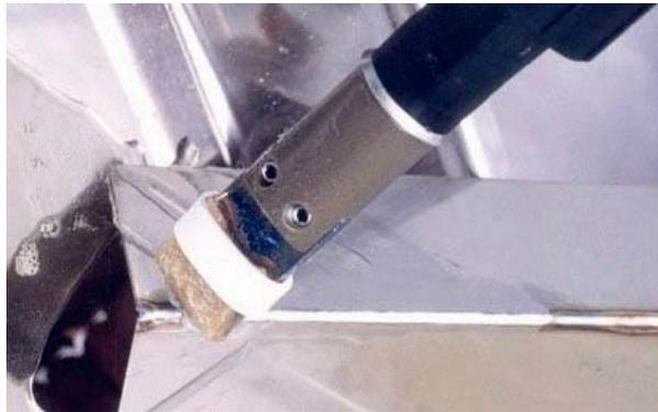
**Les systèmes CLINOX enlèvent les oxydes colorés et passivent les soudures TIG sur acier inox !** CLINOX agit par réaction électrochimique instantanée :
