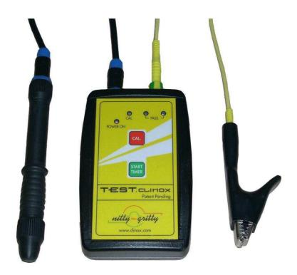
Crayon électrique permettant de disposer d'un outil simple, permettant de vérifier si le cordon possède la même résistance à la corrosion que le métal de base.
