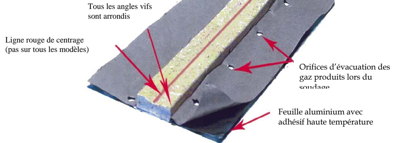
Positionner au dessus du joint à souder, la céramique centrée (vous aider de la ligne rouge de guidage si elle existe)
