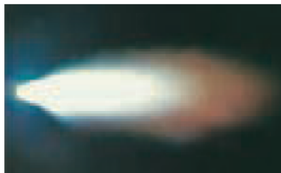
Flamme carburante (mal réglée)
