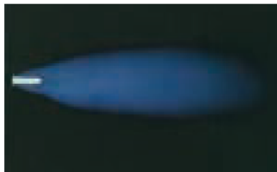
Flamme oxydante (mal réglée)
