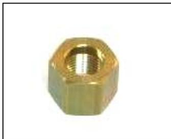
**FSE634** : Ecrou LAITON filetage métrique 16x150, pas à gauche (encoches sur écrou)- s'adapte avec olive FSE632 – *Nota : le pas à gauche est utilisé sur les gaz combustibles : Acétylène, propane,...*
