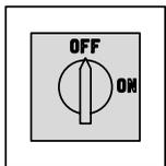
■ Togliere tensione al generatore prima di qualsiasi manutenzione e prima di sostituire o controllare i ricambi della torcia, lasciarla raffreddare.
