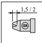
■ Sostituire l'elettrodo quando presenta un cratere superiore a 1,5 - 2 mm.
