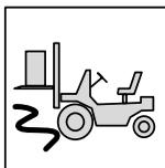
■ Non passare con carrelli o pesi sopra il cavo della torcia.
