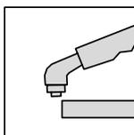
■ Non battere l'estremità della torcia, si possono danneggiare gli isolanti.
