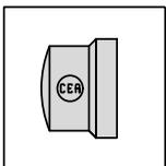
■ Sostituire la cappa quando presenta il foro allargato o deformato.
