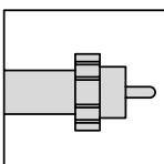
■ Attacco centralizzato. Controllare che i collegamenti dell'attacco corrispondano a quelli del generatore Plasma. Chiudere bene la ghiera.
