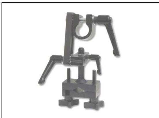
**FSM517** : Support de torche FSA518 au bout d'un bras vertical avec réglage par molette (réglage de la position verticale de la torche sur 127mm) - *Torche représentée sur photo non fournie*
