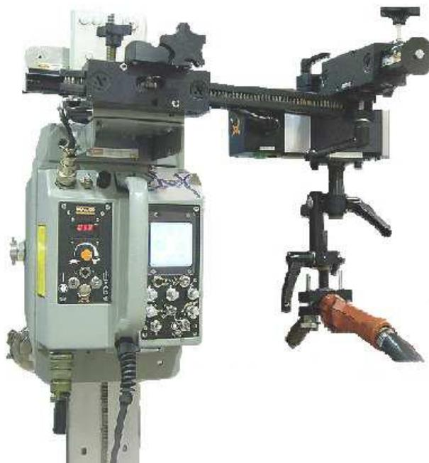
Chariot avec tête d'oscillation compacte, indépendante du chariot, qui permet de réaliser des oscillations (balayage) parallèles à la tôle ou pendulaires, avec arrêts temporisés ou non, au centre et sur les côtés de l'oscillation.
