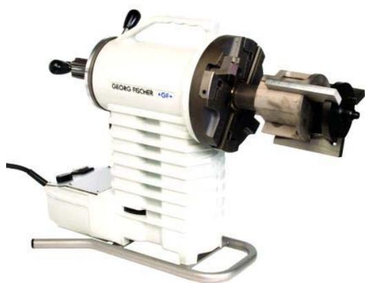
Possibilité de réaliser 3 opérations simultanément (dressage, chanfreinage, débardage) afin d'obtenir des profils de joints en V, Y ou U des extrémités des tubes en acier ou inox. Préparation optimale du joint de soudure. Serrage par l'intérieur du tube permettant un centrage parfait pour la prise en charge de petites et grandes longueurs.
