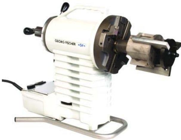
Possibilité de réaliser 3 opérations simultanément (dressage, chanfreinage, délardage) afin d'obtenir des profils de joints en V, Y ou U des extrémités des tubes en acier ou inox. Préparation optimale du joint de soudure. Serrage par l'intérieur du tube permettant un centrage parfait pour la prise en charge de petites et grandes longueurs.
