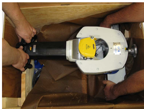
Transportez et montez uniquement la machine à deux ou à l'aide d'une grue ou appareil similaire.
