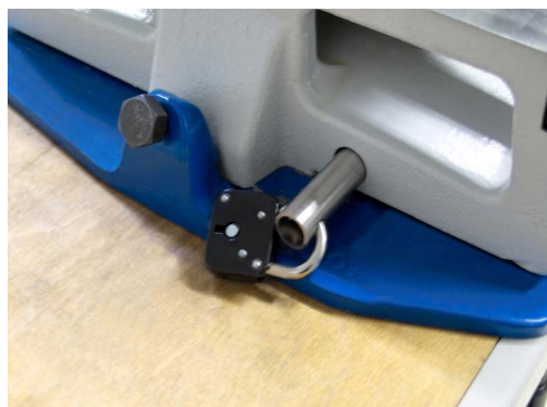
Le verrouillage du corps de rotation constitue une protection contre les utilisations non autorisées et le vol.
