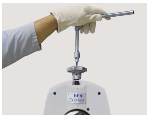
Possibilité de réglage de la dimension du tube à l'aide d'une clé à cliquet avec un embout de 8 sur la poignée étoile
