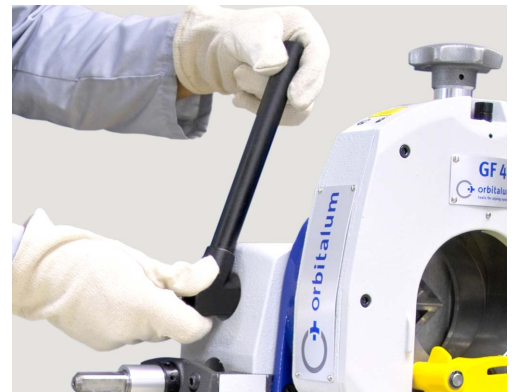
Fixation du mors de serrage
