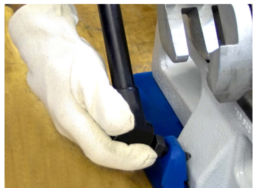
Fixation de la GF 4 sur la plaque de montage rapide
