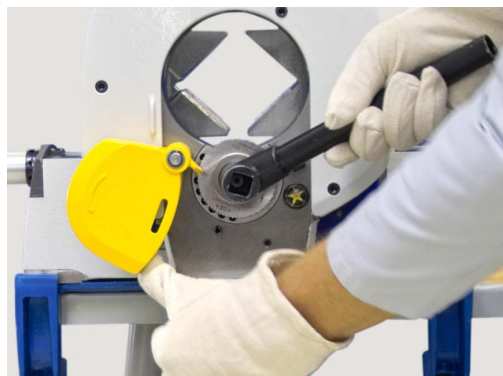
Fixation de la lame de scie/fraise
