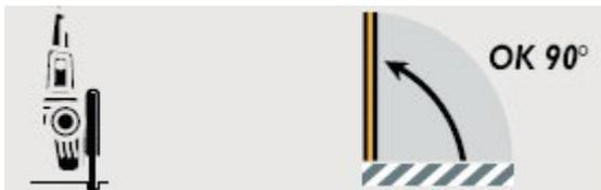
Meule à tronçonner très fine, longue durée, épaisseur 1.6 mm, diamètre 125 mm, alésage 22.2 mm
