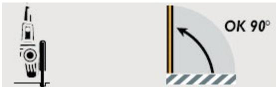
Meule à tronçonner fine, longue durée, épaisseur 2.0 mm, diamètre 230 mm, alésage 22.2 mm
