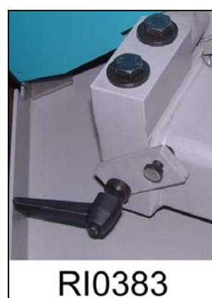
b) le patin guide lame postérieur soit déplacé dans la position la plus arrière (en dévissant le vis – 2/RI0381-et positionnant le en arrière de 40 mm)
