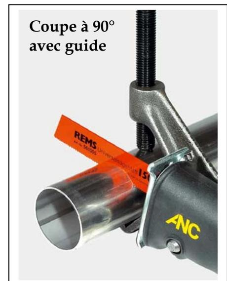
(1) Course orbitale par mouvement vertical haché de la lame de scie pour coupe énergétique, rapide, dégagement remarquable des copeaux et longue durabilité des lames de scie. Course orbitale préréglée sur roulement à aiguilles garantit un sciage puissant durable même lors d'une sollicitation extrême, par ex. pour le sciage des tubes acier.
